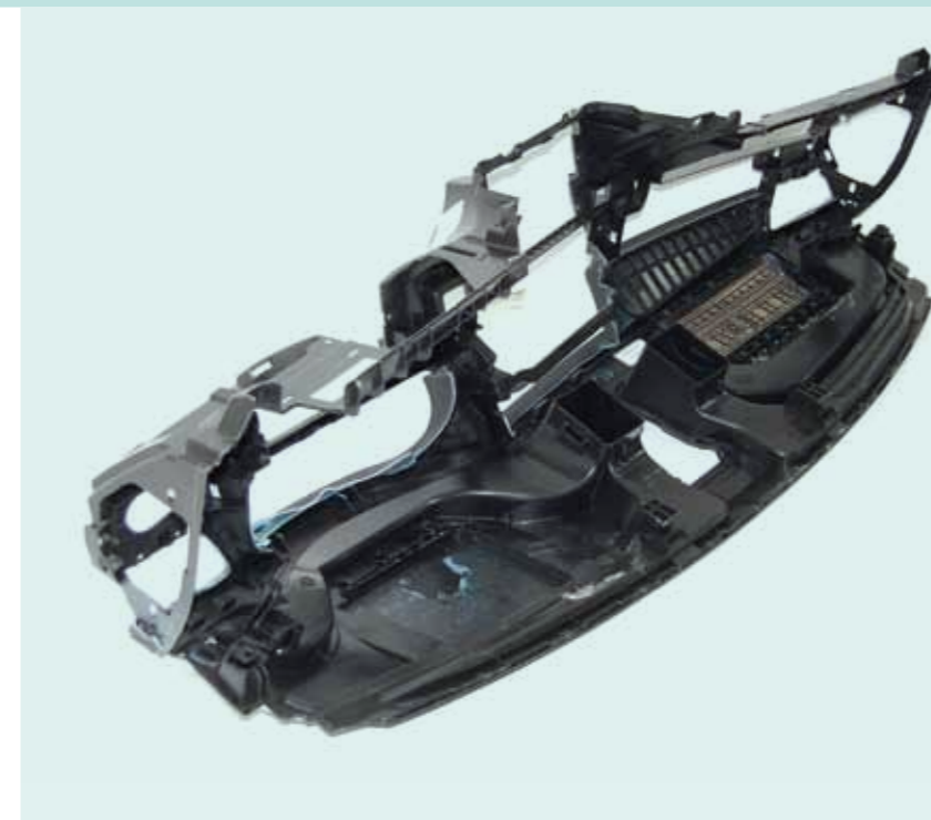
Der geschäumte Instrumententafelträger beim neuen BMW 7er ist 2,82 kg leichter als sein Vorgänger
